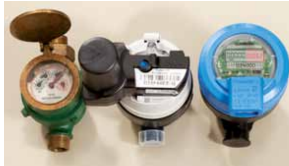
Comptador del 1910 al costat de dos comptadors intel·ligents actuals que permeten la telectura. Col·lecció del Museu Agbar de les Aigües. Arxiu Aigües de Barcelona.
