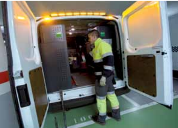
MAJOR VISIBILITAT S'ha millorat la il·luminació d'emergència dels vehicles. Era una petició dels operaris, que ara poden treballar amb més seguretat a la via pública.
